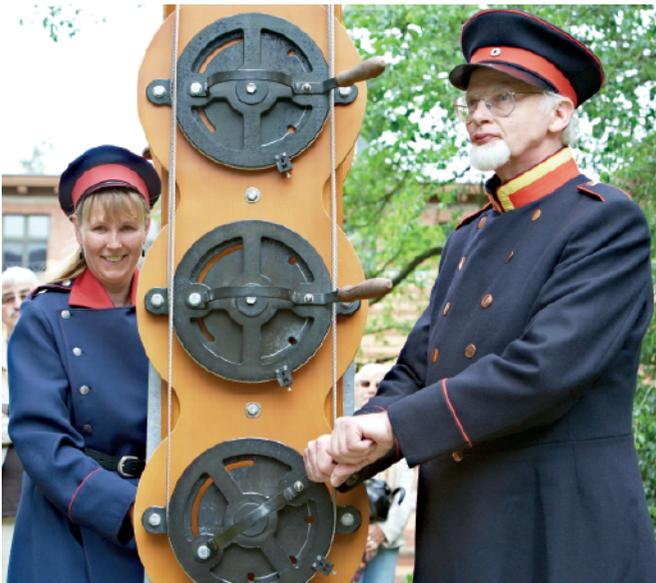
**Abb. 2:** Stellscheiben am Nachbau der Signalanlage von Station 4 Potsdam (Foto: R. Arlt, Potsdam, Juni 2009)
